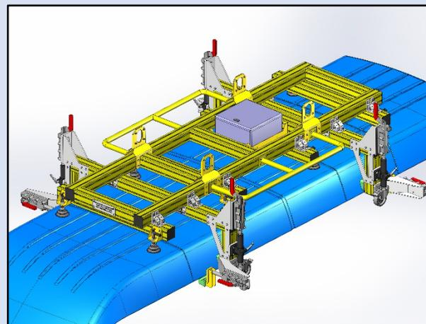
Système d'essai de capot
